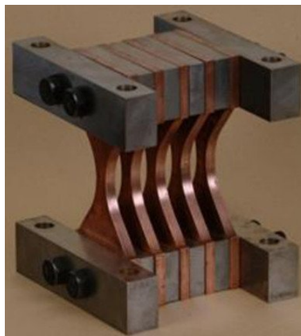
Figura 8.5: Ejemplo de un disipador de energía histerético (o de fluencia) ADAS. La energía sísmica se disipa mediante la deformación plástica de las placas metálicas curvas.
